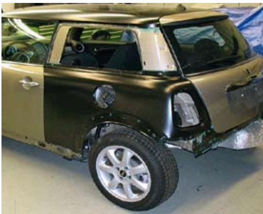
ACHTERSCHERM, ACHTERPANEEL EN DAK VAN EEN MINI EN VAN EEN BMW 3-SERIE VERVANGEN DOOR MIDDEL VAN DE HYBRIDE VERBINDING LIJM IN COMBINATIE MET PONSNAGELS EN POPNAGELS
