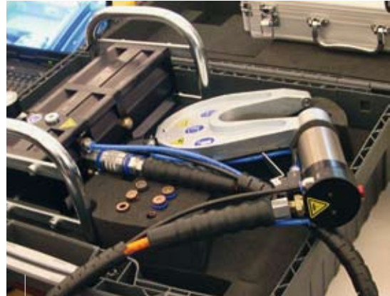
SPECIAAL VOOR BMW ONTWIKKELD PONSNAGELAPPARAAT
