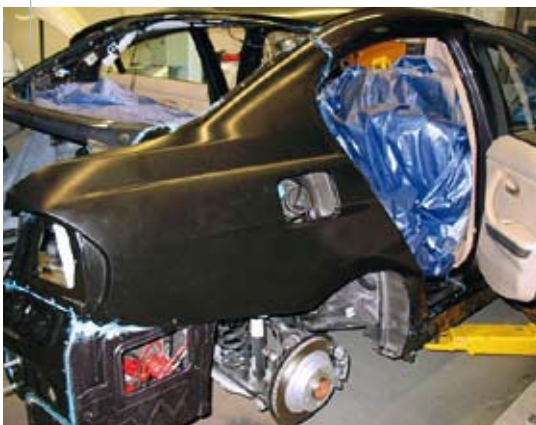
ACHTERSCHERM, ACHTERPANEEL EN DAK VAN EEN MINI EN VAN EEN BMW 3-SERIE VERVANGEN DOOR MIDDEL VAN DE HYBRIDE VERBINDING LIJM IN COMBINATIE MET PONSNAGELS EN POPNAGELS
